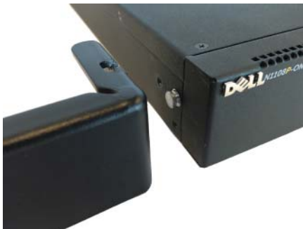
Figura 1-6. Fijación de los soportes
